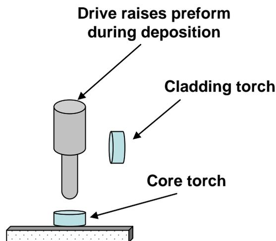
**Figure 2.14:** VAD preform fabrication technique.
